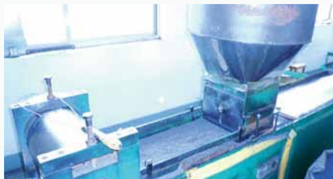
Рис. 6. Бункер-дозатор ТРГ-пуха (китайское производство)
