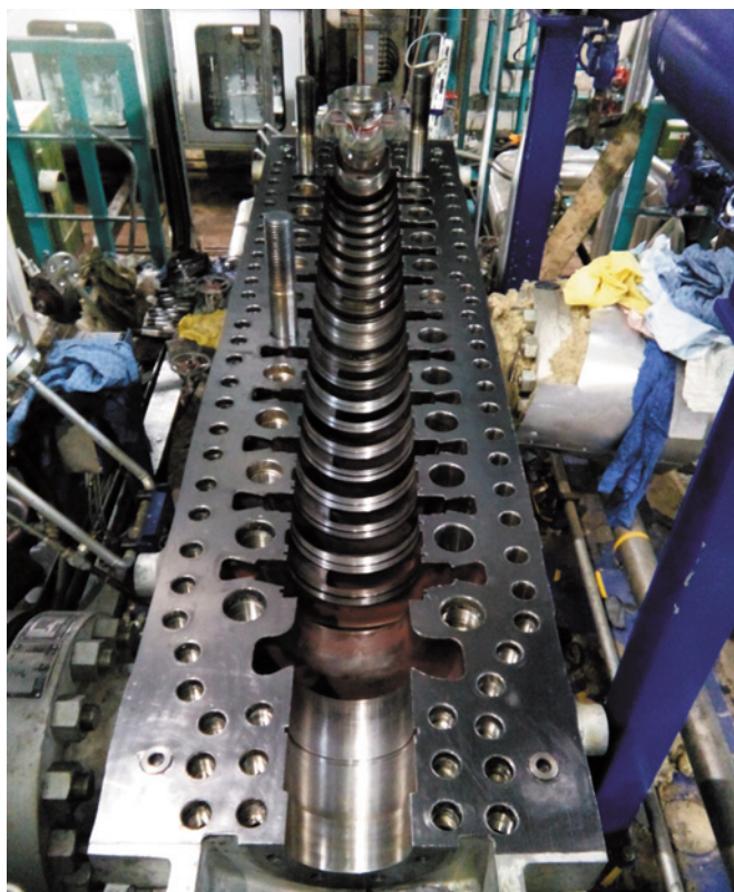
Рис. 5. Уплотнение на горизонтальном разъеме
