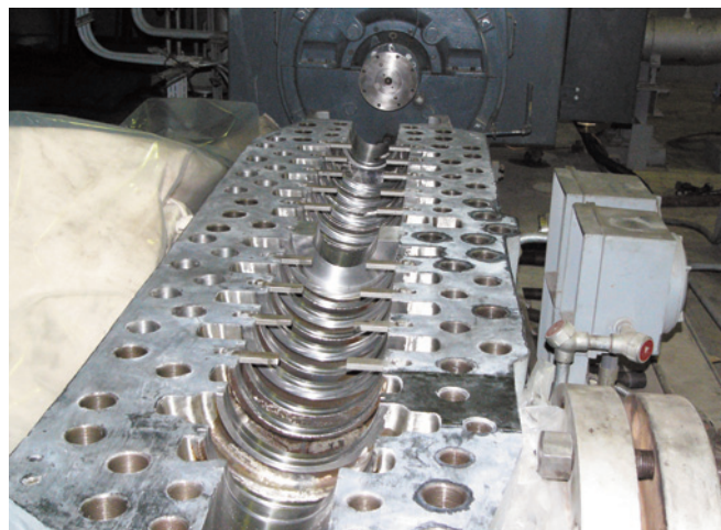
Рис. 1. Разъем насоса, подготовленный к сборке
